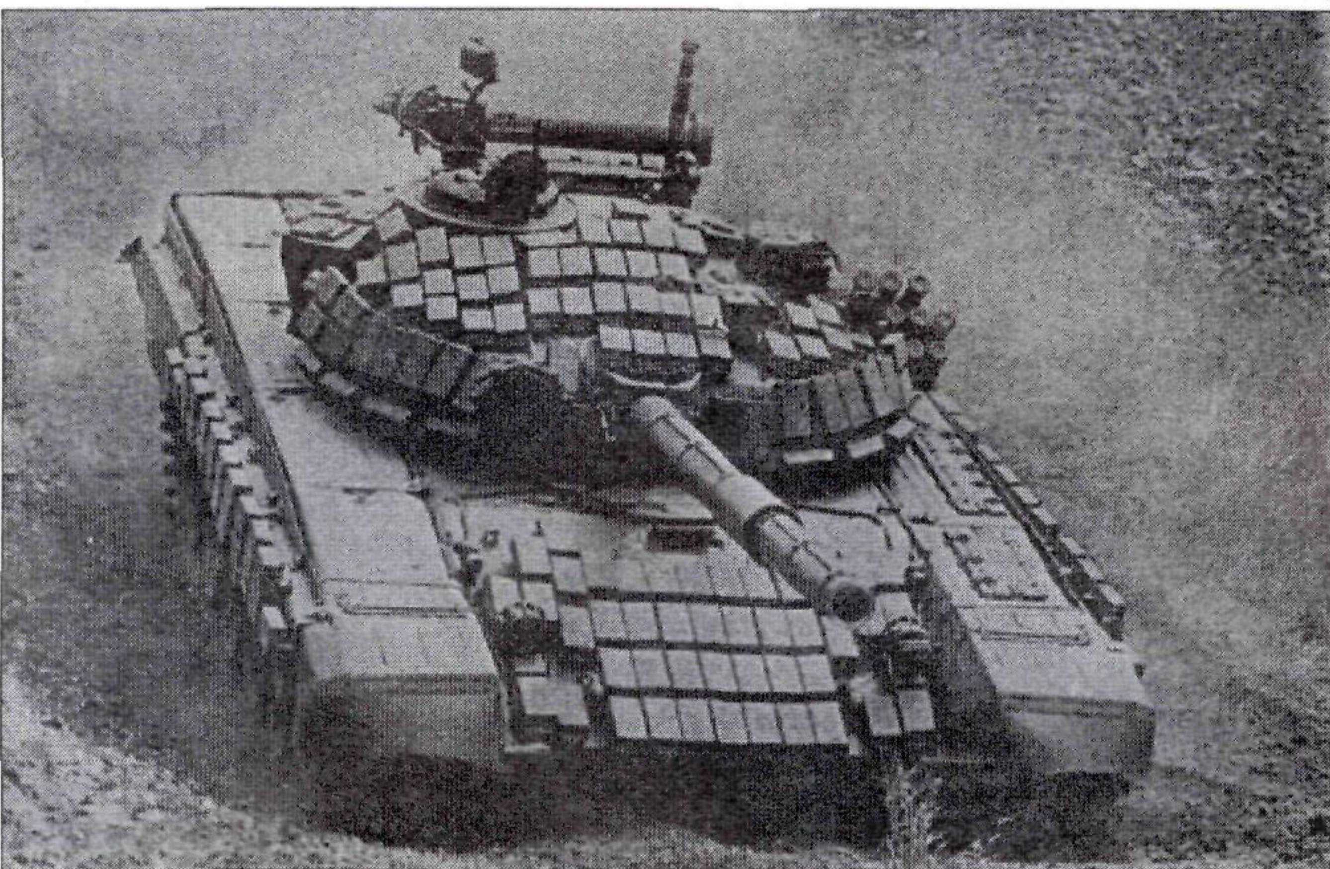
По опыту боев в Ливане в 1982 г все советские танки четвертого поколения, как и этот Т-72, получили активную "броню"
